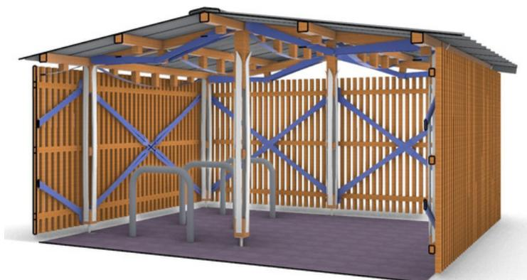
Vues en 3D d'un l'abri à vélos fermé **personnalisé** avec bardage en barres de mélèze
